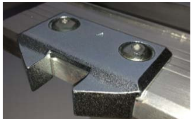
Verschlussnase (Nietausführung) für Alto 175 Trike
